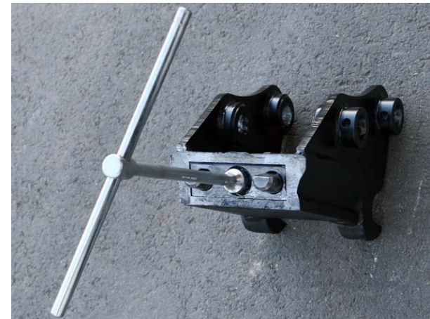
Abb. 2: Schnellkupplung mit aufgestecktem Verriegelungswerkzeug
