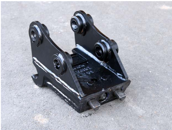
Abb. 1: Schnellkupplung mit Aufnahme für Verriegelungswerkzeug
