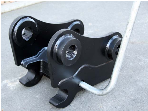
Abb. 3: Schnellkupplung mit abnehmbarem Verriegelungshebel
