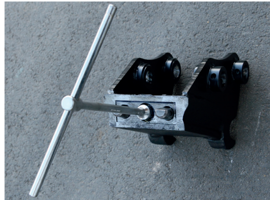
Abb. 2: Schnellkupplung mit aufgestecktem Verriegelungswerkzeug
