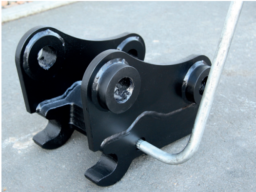
Abb. 3: Schnellkupplung mit abnehmbarem Verriegelungshebel
