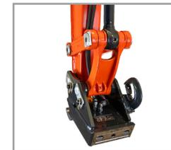
10. Schließen Sie die Hydraulikleitungen an den Schnellwechsler an.
