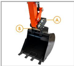
2. Senken Sie den Ausleger mit der Schnellwechseleinrichtung (A) ab, bis die Aufnahmeclawen in die Aufnahmebohle (B) greifen.
