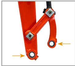
1. Reinigen Sie die Bolzenaugen (Pfeile) jeweils beidseitig. Benetzen Sie sie mit etwas Schmierfett, siehe Kapitel 3.1 „Betriebsstoffe“.
