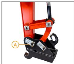
1. Nehmen Sie die Bolzensicherung (A) aus dem Bolzen heraus.
