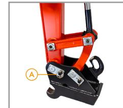
9. Prüfen Sie die Bolzensicherung (A) auf korrekten Sitz.
