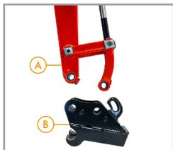
3. Fahren Sie mit dem Ausleger (A) aus dem Schnellwechsler (B) raus.
