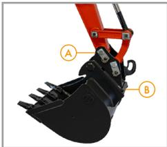
3. Senken Sie die Schnellwechseleinrichtung (A) vollständig in die Schnellwechselaufnahme (B) ab.
