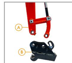
4. Fahren Sie mit dem Ausleger (A) aus dem Schnellwechsler (B) raus.
