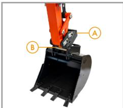
2. Senken Sie den Ausleger mit der Schnellwechseinrichtung (A) ab, bis die Aufnahmeklauen in die Aufnahmewelle (B) greifen.
