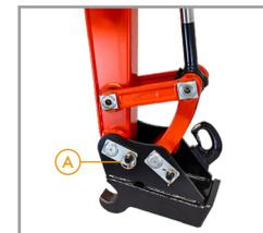
9. Prüfen Sie die Bolzensicherung (A) auf korrekten Sitz.
