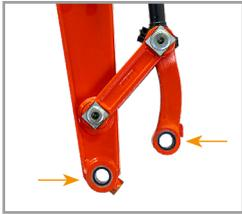
1. Reinigen Sie die Bolzenaugen (Pfeile) jeweils beidseitig. Benetzen Sie sie mit etwas Schmierfett, siehe Kapitel 3.1 „Betriebsstoffe“.
