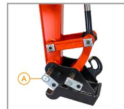
2. Entfernen Sie die Hydraulikleitungen vom Schnellwechsler.
