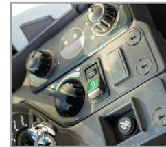
7. Schließen Sie die Verriegelung der Schnellwechseleinrichtung mittels Schalter im Führerhaus (A).
