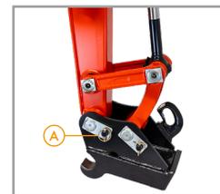
1. Nehmen Sie die Bolzensicherung (A) aus dem Bolzen heraus.
