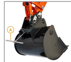
7. Führen Sie den Öffnungsschlüssel in die Werkzeugaufnahme.
