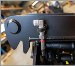
1. Hydraulikleitungen des Gerätes mit den dafür vorgesehenen Hydraulikanschlüssen der Erdbaumaschine verbinden.\*
