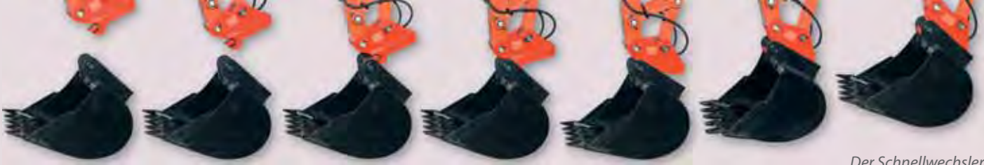
Der Schnellwechsler im geöffneten und verriegelten Zustand.
