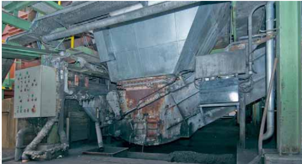
Ein Spezialcontainer für den anfallenden Schwelkoks ist in der Müllpyrolyseanlage Burgau rund um die Uhr in Betrieb.
