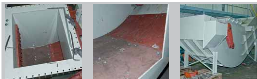
Der Ersatzcontainer für Burgau wird mit neuen Henle-Hardox-Teilen aufgearbeitet.
