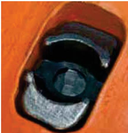
perfekt für diese Art von Arbeiten geeignet. Sie entschieden sich außerdem, den neuen mechanischen Verschluss zu verwenden, mit dem sich das System leicht an der Oberseite des Zahns an- und abmontieren lässt. Mit dieser Lösung kann ein Wechsel der Zähne individuell erfolgen, ohne dass danebenliegende Zähne demontiert werden müssen. Das war hier besonders von Vorteil, da die Zähne bei diesem Löffel in einem ziemlich kleinen Abstand angeordnet waren.
