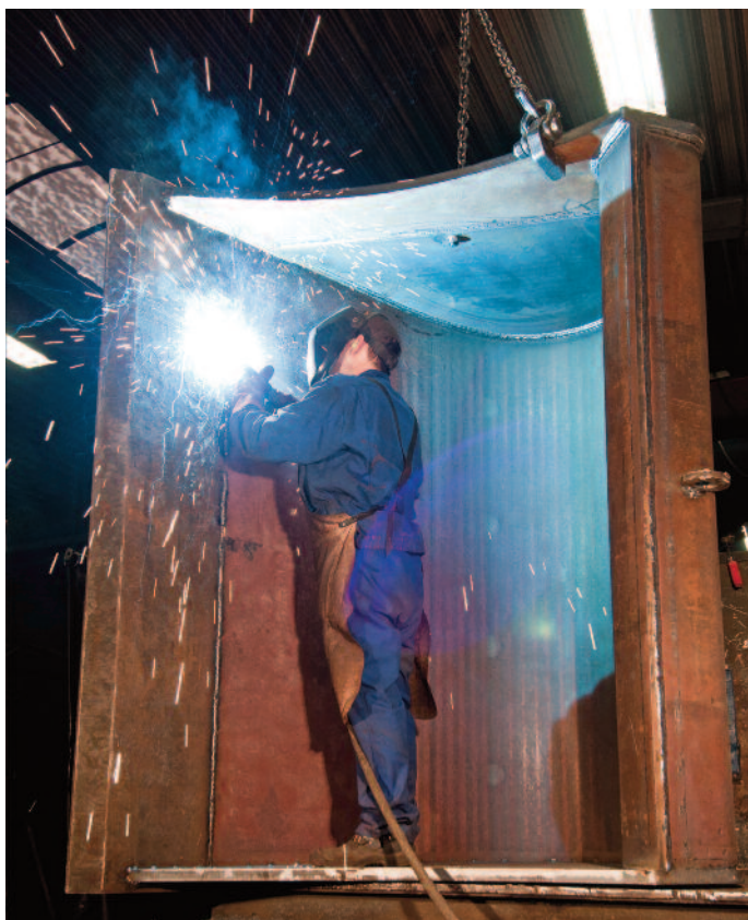
Maßgeschneiderte Unikate entstehen auch bei Henle Baumaschinentechnik – hier ein 2,3 m breiter Speziallöffel für Creaton.
